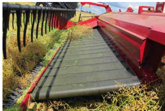
Specjalny pas transportujący ściętą masę żniwną do lewej strony hedera ma głębokość nieco ponad 1 m i podziałkę między listwami zabierakowymi równą 30 cm.
