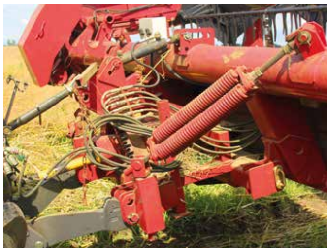
Pakiet sprężyn odciążających pozwala na bardzo dobre i szybkie kopiowanie konturów podłoża.
