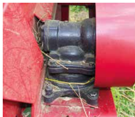
Belkę nożową budzi do pracy przekładnia planetarna typu Schumacher.
