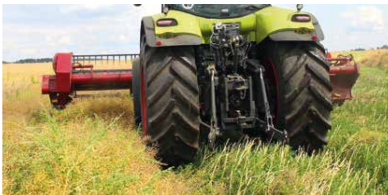
Pokos odkładany jest wyłącznie z lewej strony. Ciągnik o szerokości całkowitej 2,55 m sporadycznie najechał na brzeg wału roślin.
