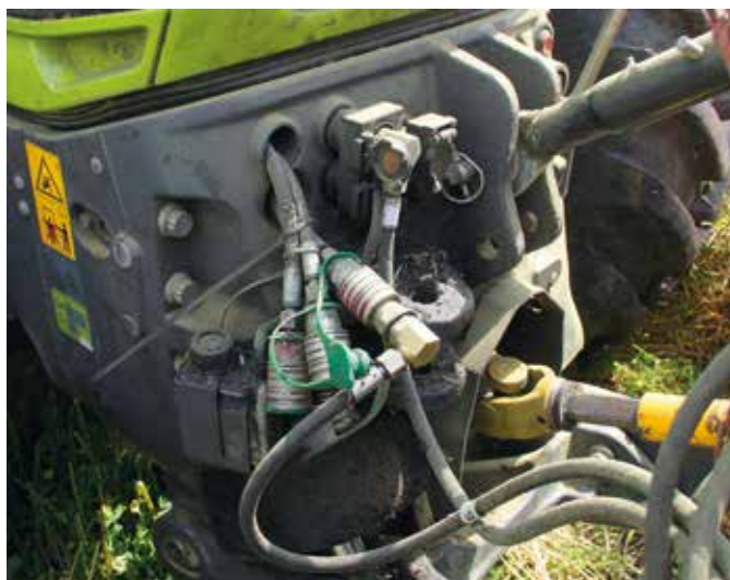
Producenci ciągników póki co nie są w stanie sprostać potrzebom hydraulicznym montowanej na przód pokosówki. Użytkownik musi dołożyć szybkozłączka we własnym zakresie.
