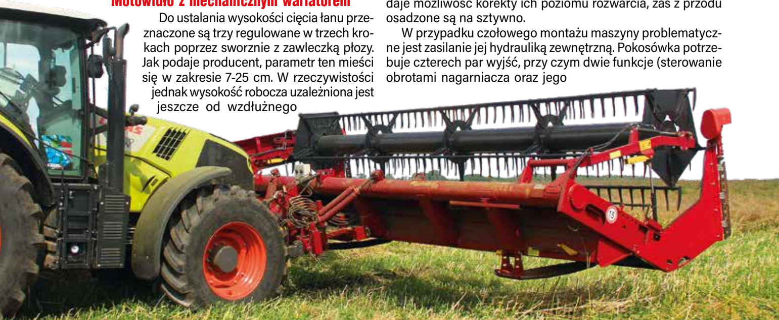
Udźwig przedniego podnośnika, liczony w osiach końcówek dolnych ciężkiej, równy blisko 6 t okazał się w zupełności wystarczający dla ważącej 2,3 t pokosówki.
