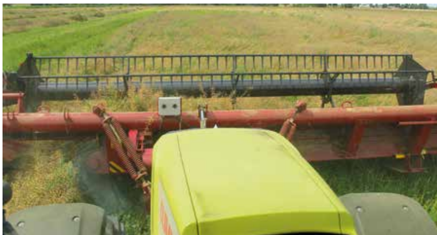
Widoczność na pracę podzespołów hedera z ciągnika jest przyzwyczajona. Z pewnością większy komfort ich obserwacji daje montaż maszyny przy tylnym TUZ-ie.
